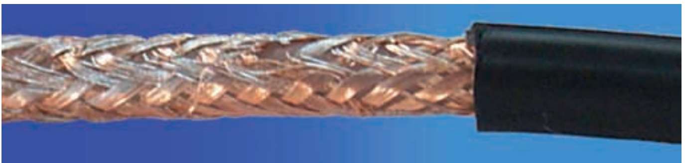
Foto 3: Trenza de aluminio cobreado: con un simple raspado de la superficie puede observarse la aparición del aluminio. En este ejemplo son además hilos de diámetro 0,12 mm.
