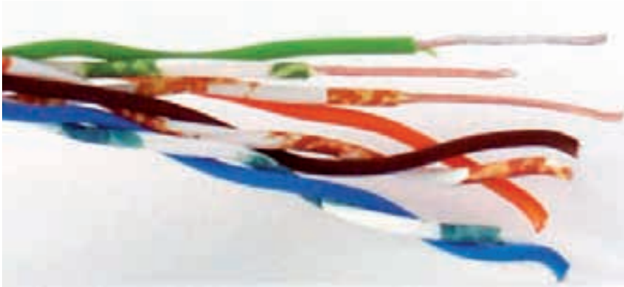
Foto 4: Cable UTP en el que puede observarse cómo el conductor verde ha perdido el baño de cobre, dejando el aluminio al descubierto.
