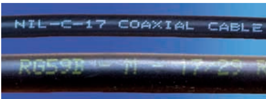
Foto 2: Dos cables marcados con nomenclatura similar a MIL-C-17 con el objetivo de dar apariencia de cumplimiento de la norma.
