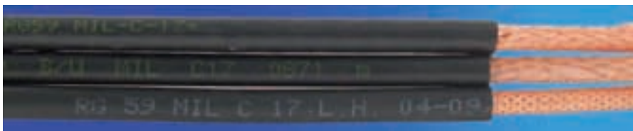
Foto 1: Tres cables marcados con la norma MIL-C-17: sólo uno de ellos se ajusta a la misma.
